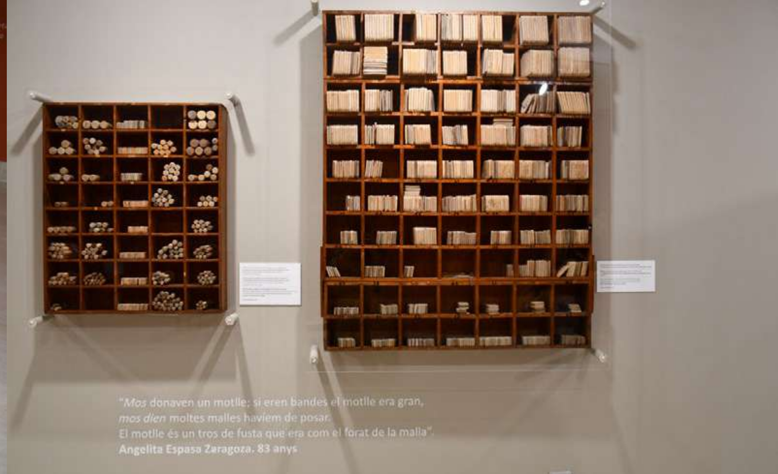
▲ Moldes redondos de diferentes tamaños según el paño a confeccionar. Los utilizaban las rederas para hacer un tipo de malla pequeña: la corona. Son las partes que van situadas en los bajos y en la cola del arte y soportan más fricción y peso. Moldes planos de diferentes tamaños según el paño a confeccionar. Los utilizaban las rederas para hacer mallas grandes: bandas, visera, golerón, fisca y caserete. Colección Redsinsa S.A.
